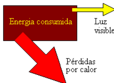
(Fig. 2.2) Consumo de energía para producir luz visible incandescente
