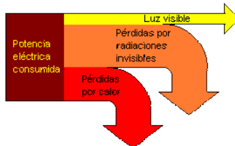
(Fig. 1.19) Energía eléctrica consumida para producir luz visible
